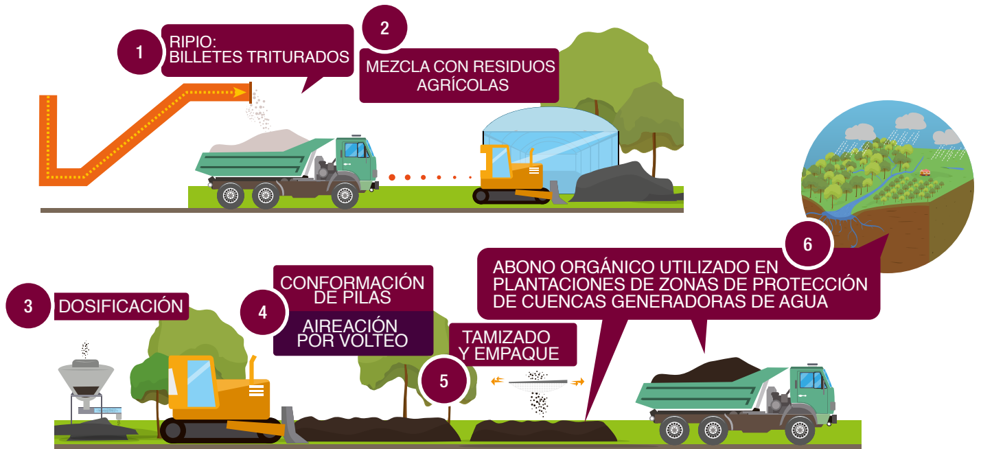
DIAGRAMA 10 | DETALLE DEL CICLO DE APROVECHAMIENTO DEL RIPIO Y SU USO EN LA REFORESTACIÓN
